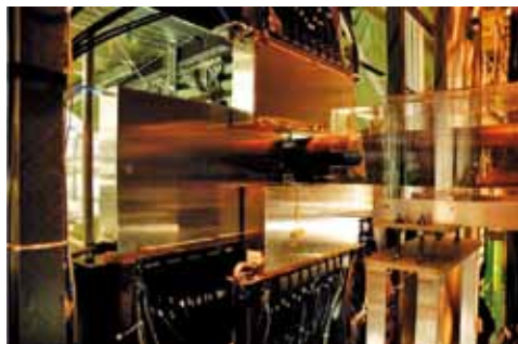
Figura 6: Inner Tracker (fabricado pola USC) instalado como parte do detector LHCb
